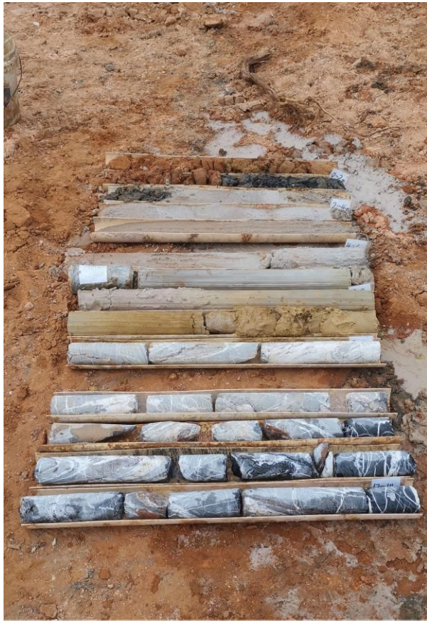
项目名称:广西广投北海绿色生态铝一期项目年产200万吨氧化铝及配套工程岩土工程勘察项目(1#综合办公楼、多功能厅、2#3#生产值班楼、4#维护楼、5#6#生产值班楼、7#食堂、架空连廊) 钻孔编号:ZK50 深度(m):14 描述员:梁小宁 勘察单位:广西壮族自治区水利电力勘测设计研究院有限责任公司 拍照时间:2023-12-16 17:33:54 钻孔类型:技术孔 项目负责人:甘彬 编录员:杨文韬
