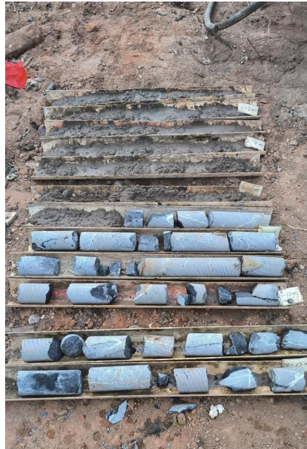
项目名称:广西广投北海绿色生态铝一期项目年产200万吨氧化铝及配套工程岩土工程勘察项目(1#综合办公楼、多功能厅、2#3#生产值班楼、4#维护楼、5#6#生产值班楼、7#食堂、架空连廊) 钻孔编号:ZK95 钻孔类型:鉴别孔 深度(m):12 项目负责人:甘彬 描述员:韦红雄 编录员:覃巧 勘察单位:广西壮族自治区水利电力勘测设计研究院有限责任公司 拍照时间:2023-12-21 15:08:32
