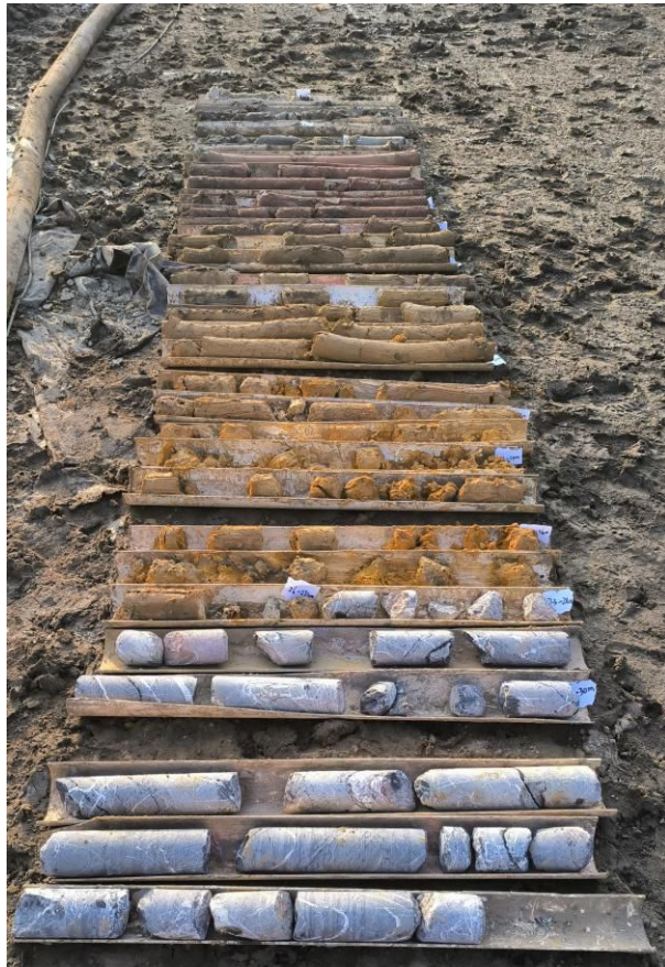
项目名称:广西广投北海绿色生态铝一期项目年产200万吨氧化铝及配套工程岩土工程勘察项目(1#综合办公楼、多功能厅、2#3#生产值班楼、4#维护楼、5#6#生产值班楼、7#食堂、架空连廊) 钻孔编号:ZK79 钻孔类型:技术孔 深度(m):32.7 项目负责人:甘彬 描述员:陆高正 编录员:覃巧 勘察单位:广西壮族自治区水利电力勘测设计研究院有限责任公司 拍照时间:2023-11-28 16:46:10
