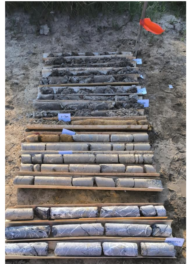
项目名称:广西广投北海绿色生态铝一期项目年产200万吨氧化铝及配套工程岩土工程勘察项目(1#综合办公楼、多功能厅、2#3#生产值班楼、4#维护楼、5#6#生产值班楼、7#食堂、架空连廊) 钻孔编号:ZK40 深度(m):18 描述员:韦红雄 勘察单位:广西壮族自治区水利电力勘测设计研究院有限责任公司 拍照时间:2023-11-25 16:35:48 钻孔类型:鉴别孔 项目负责人:甘彬 编录员:杨文韬
